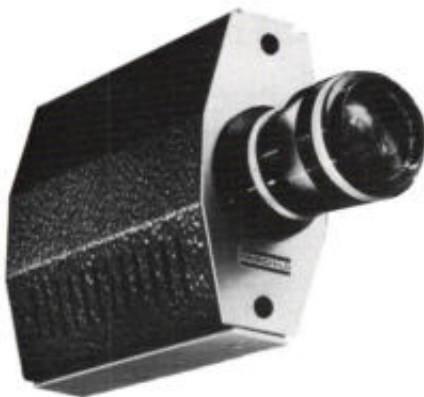
Afb. 3. Fairchild TV-camera met CCD-vlaksensor die 488 \times 380 beeldelementen bevat.
