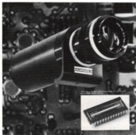
Met CCD-lijnsensorcamera's van Fairchild kunnen, afhankelijk van de uitvoering, resoluties tot 2048 beeldelementen worden verkregen.
