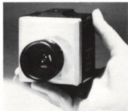
Afb. 5. Ook RCA ontwikkelde een zeer compacte TV-camera met CCD-opnemer. De kleine afmetingen worden geïllustreerd door een vergelijking van camera en vlaksensor met een 2/3-inch vidicon.
