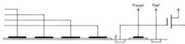
Fig. 18. Uitgangsschakeling van het P^2 CCD. Het uitgangcontactgebied D is verbonden met de stuur-elektrode van een MOS-transistor, die extern als aanvoervolger („source follower”) wordt geschakeld. Een tweede MOS-transistor, bediend door een „reset”spanning V_{reset} , brengt de uitgang tussen de ladingpakketten door telkens weer op de referentiepotentiaal V_{ref} . De MOS-transistoren zijn met het P^2 CCD meegeïntegreerd.
